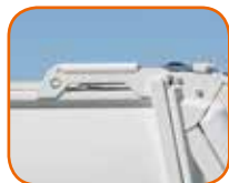
4 Vérins de levage sur le toit de la trémie
